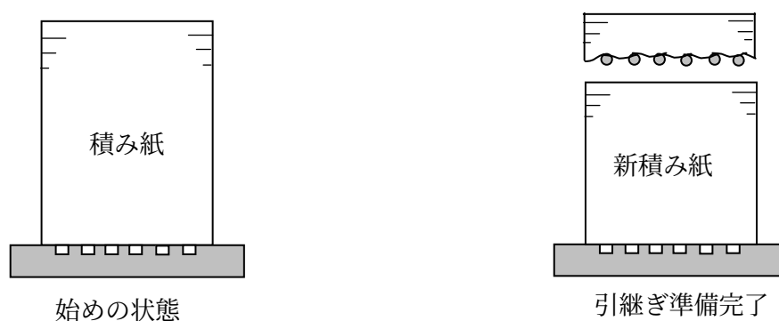
図 3.17 ノンストップによる積み紙の引継ぎ
