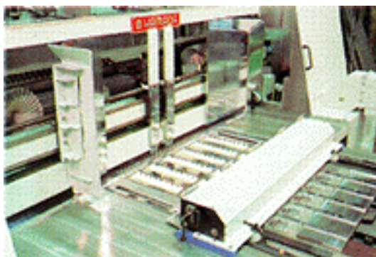
図 3.98 キッカーフィードの給紙機構
