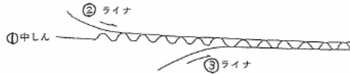
図 3.77 両面段ボールを製造する順序の概念図
