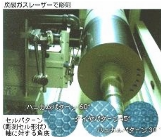
図 3.104 セラミック加工と標準的な各種セルパターン
