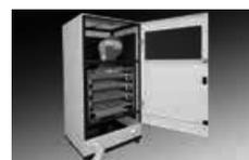
各印刷ユニットより回収したVOCを光触媒を利用したフィルターにより無害化します。
